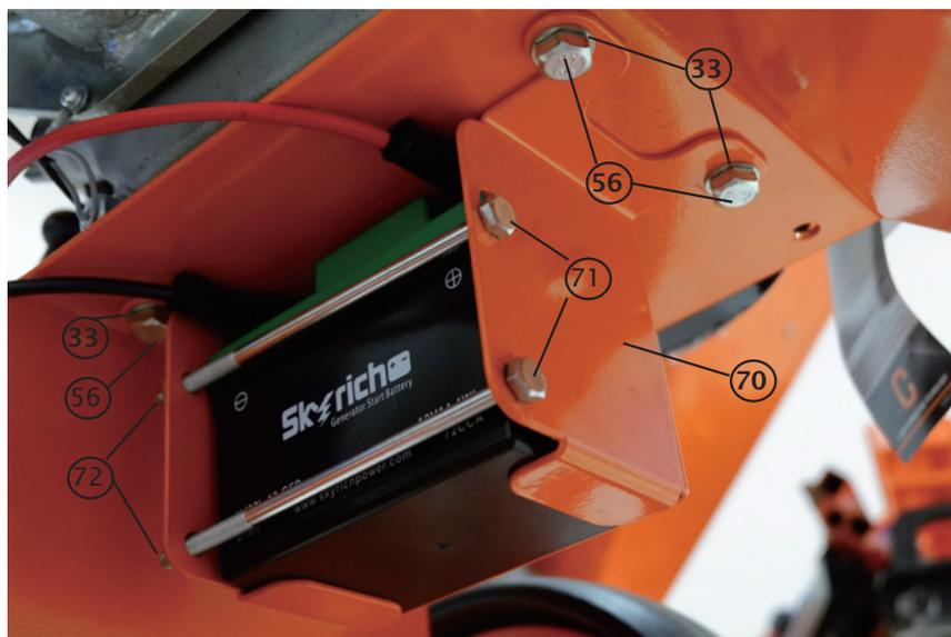
Conecte los cables de la batería a los bornes de la batería (rojo a positivo (+)). Coloque la batería en la bandeja y fijela con los dos pernos M5 x 125 (71) y tuercas (72).
