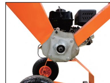
**Funcionamiento del motor de la trituradora de gasolina FM6DD/FM6DDES NO ARRANQUE EL MOTOR POR PRIMERA VEZ SIN LLENARLO CON 600 ml DE ACEITE. El motor puede tener residuos de aceite, pero la astilladora no se suministra precargada.**
