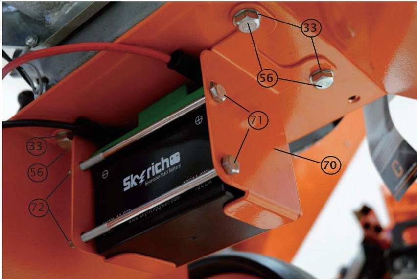
Connectez les câbles de la batterie aux bornes de la batterie (le rouge au positif (+)). Placez la batterie sur le support et fixez-la à l'aide des deux boulons M5 x 125 (71) et des écrous (72).
