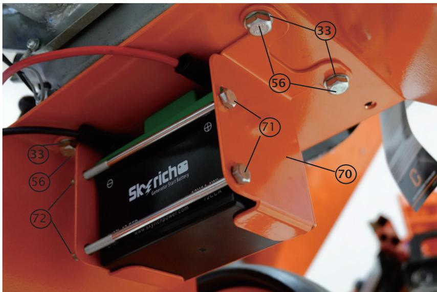
Collegare i cavi della batteria ai terminali sulla batteria (dal rosso al positivo (+)). Posizionare la batteria sull'alloggiamento e fissarla utilizzando i due bulloni M5 x 125 (71) e i dadi (72).
